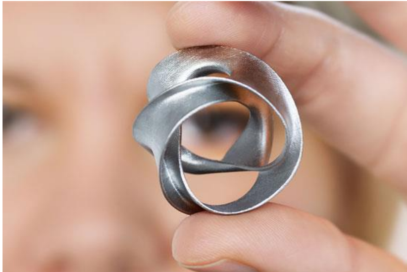
Ilustración 15 Figura realizada con metal mediante impresión 3D
