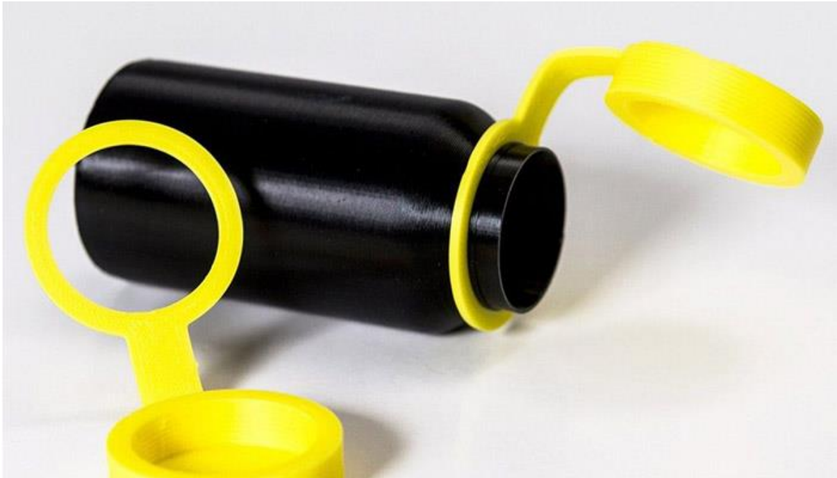
Ilustración 21 Figura realizada con Polipropileno en impresora 3D
