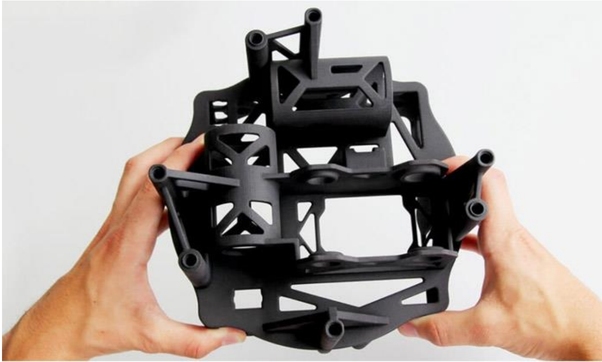
Ilustración 22 Figura realizada con Nylon en impresora 3D
