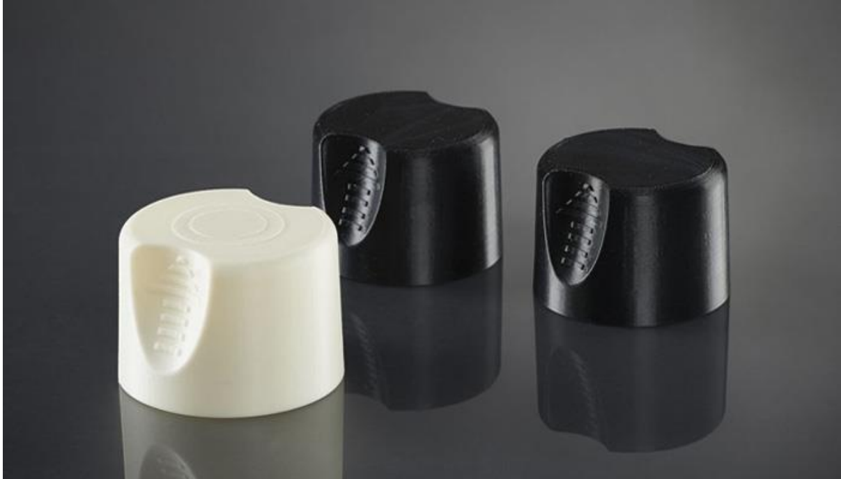
Ilustración 16 Figuras realizados con ASA mediante impresión 3D
