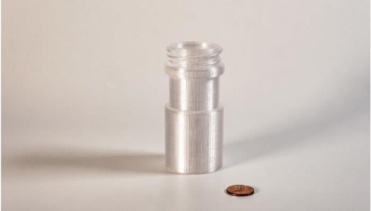
Ilustración 19 Figura hecha de PC en impresora 3D
