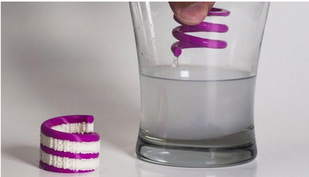
Ilustración 25 Objeto hecho de materiales solubles por medio de una impresora 3D
